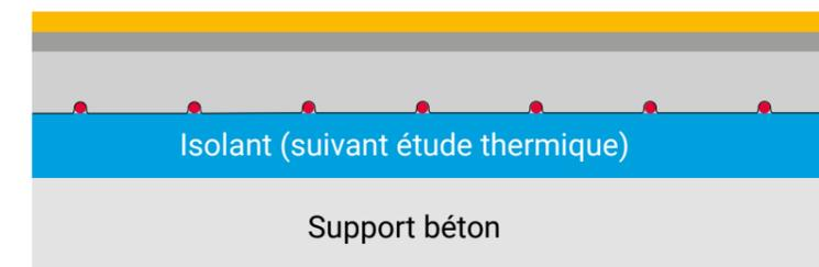
Trame de plancher chauffant rénovation
