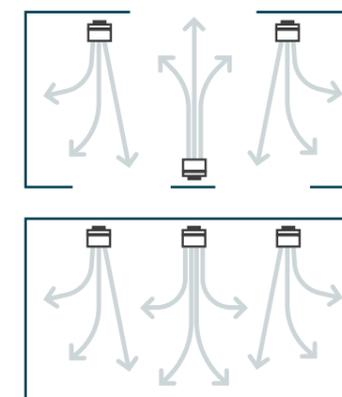
Et aussi vérifier la portée de soufflage maximale des aérothermes qui varie selon la puissance des appareils :
