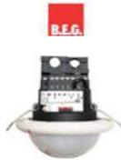
PD4-M-1C-C-FP détecteur de présence couleur maître 1 canal 2x10m faux plafond type de pose: faux plafond champ de détection: 360° zones de détection h=2,50m: 40 x 5 m de biais, 20 x 3 m de face, 8 m en vertical canal 1: NO-2300W
