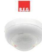
PD4N-1C-C-AP détecteur de mouvement spécial couloir 2x 10m en saillie type de pose: en saillie champ de détection: 360° zones de détection h=2,50m: 40 x 5 m de biais, 20 x 3 m de face, 8m en vertical canal 1: 2300W cos 1
