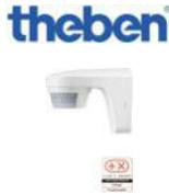
Détecteur de mouvement blanc pour installation extérieur. Angle de détection 180°, portée 12 m à 2.5m de Hauteur. IP55. Contact alimenté 10A. Coupure lampe LED max 100W. temporisation 1 sec à 20 min.
