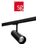
Tube Eco spot minimaliste suspendu rail 3 allumages pour magasins noir LED 88 lumens-W coupeure de phase IRC supà90 SDCM 2 durée de vie:L80-B20 supà50 000 heures faisceau 32° matériau:aluminium et PC 230V classe I IP20
