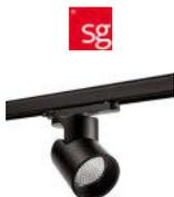
Aneto spot pour rail 3 allumages noir LED 84 lumens-W non dimmable IRC sup à 90 SDCM 2 faisceau de 32° durée de vie : L90-B10sup à 100 000 heures matériau : aluminium 230V Classe I IP20
