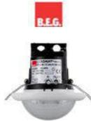
PD4-M-1C-FP détecteur de présence maître 1 canal 360° et 24m en faux plafond type de pose: faux plafond champ de détection: 360° zones de détection h=2,50m: 24m de biais, 8m de face, 6.40m en assise canal 1: NO-2300W cos 1-1150
