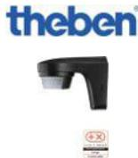
Détecteur de mouvement noir pour installation extérieur. Angle de détection 180°, portée 12 m à 2.5m de Hauteur. IP55. Contact alimenté 10A. Coupure lampe LED max 100W. temporisation 1 sec à 20 min.
