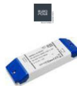
Alimentation SMART TRIAC 24. Convertisseur électronique pour éclairage LED tension constante et variation d'intensité lumineuse. Entrée : 220-240VAC. Sortie : 24VDC/1,25A. Classe II, IP20. Dimmable, variation TRIAC.
