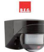
LC-Click-N 140-NR détecteur de mouvement LC-Click 140° + 360° noir type de pose: mural champ de détection: 140° horizontal et 360° en vertical zones de détection h=2,50 m: de biais 12m, frontale 4m, verticale 2m canal 1: 1000W cos 1
