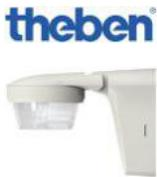
Détecteur de mouvement blanc pour installation extérieur. Angle de détection 360°, Diamètre 32 m à 2.5m de haut. IP66. Contact alimenté 10A. Coupure lampe LED max 500W. temporisation 1 sec à 20 min.
