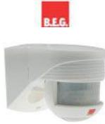
LC-Click-N 200-BL détecteur de mouvement LC-Click 200° + 360° blanc type de pose : mural champ de détection : 200° horizontal et 360° en vertical zones de détection h=2,50 m: de biais 12m, frontale 4m, verticale 2m canal 1: 1000W cos 1
