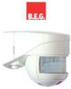
LC-Click-140-BL détecteur de mouvement LC-Click 140° blanc type de pose: mural champ de détection: 140° horizontal zones de détection h=2,50 m: de biais 12m, frontale 4m canal 1 : 1000W cos 1(μ contact) LED 30W maxi
