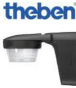
Détecteur de mouvement noir pour installation extérieur. Angle de détection 360°, Diamètre 32 m à 2.5m de haut. IP66. Contact alimenté 10A. Coupure lampe LED max 500W. temporisation 1 sec à 20 min.
