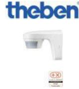
Détecteur de mouvement blanc pour installation extérieur. Angle de détection 150°, portée 12 m à 2.5m de Hauteur. IP55. Contact alimenté 10A. Coupure lampe LED max 100W. temporisation 1 sec à 20 min.
