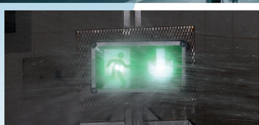
Test d'étanchéité au Laboratoire d'essais produits et matériaux Legrand
