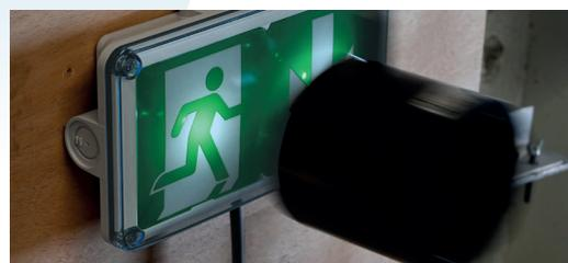
Test de chocs au Laboratoire d'essais produits et matériaux Legrand
