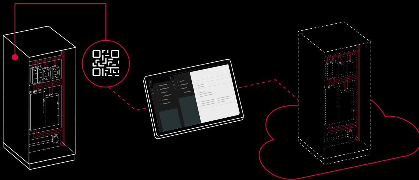
Le code QR relie les armoires électriques physiques de Rittal à la pochette à plans numérique dans l'environnement du Cloud EPLAN. Toute la documentation sur les schémas électriques spécifiques au projet peut y être stockée rapidement et aisément.
