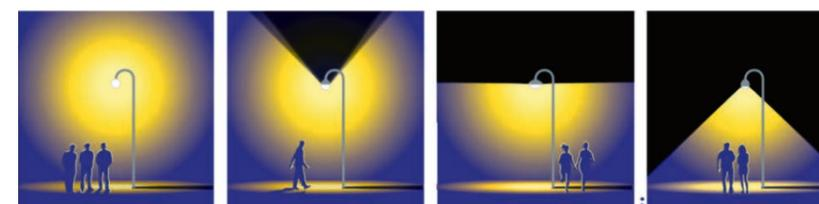
● Éclairage non conforme ● Éclairage non conforme ● Éclairage non conforme ● Éclairage conforme
