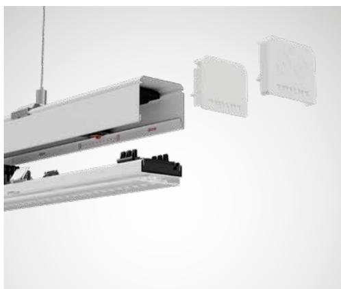
Les platines-appareillages E-Line Pro sont compatibles IP50. Grâce à une barrette d'étanchéité entre les luminaires, à des joints d'étanchéité et à l'embout adapté, l'ensemble du système devient IP50.
