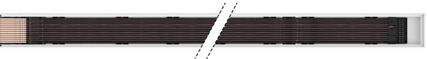
Longueur du profil-support de 368,5 mm, 737,5 mm, 1 475 mm, 2 212,5 mm, 2 950 mm ou 4 425 mm
